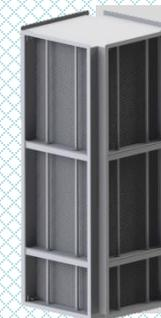
Аппарат разбирается, снимаются мерки пакета пластин, изготавливается матрица с гофрой HESS, изготавливается новый пакет пластин, который помещается в исходную раму. Снижаются сроки, расходы на металлообработку. Аппарат имеет исходные размеры.
